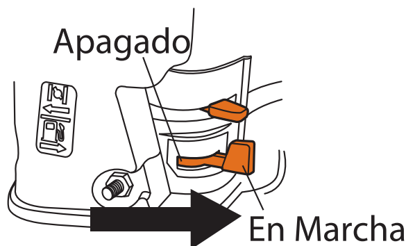
Figura 23 - Válvula de combustible
