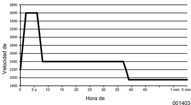
**Figura 3-9. Perfil de baja velocidad del funcionamiento**
