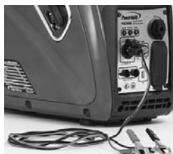
Figura 3-4. Conector de entrada del cargador de baterías
