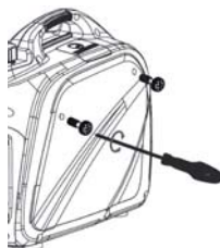
Figura 4-3. Retiro de la cubierta lateral
