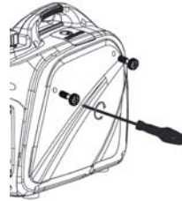
Figura 2-6. Retiro de la cubierta lateral
