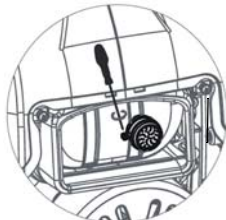
Figura 4-7. Tamiz del supresor de chispas
