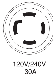
Figura 7 - Receptáculo de 120/240 VAC, 30 amperios
