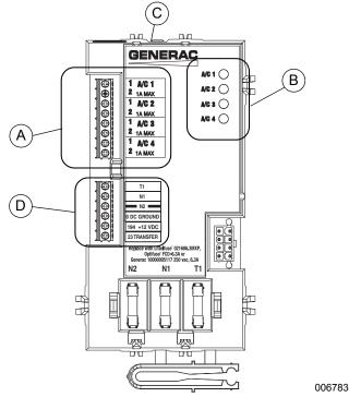
Figure 2-2. Smart A/C Module (SACM)
