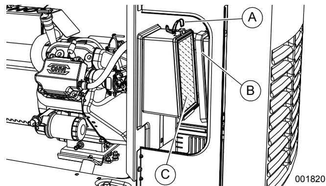
Figure 4-4. Entretien de l'épurateur d'air (10 kW)
