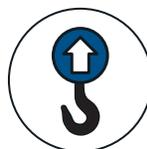
Point de levage. Attacher les accessoires de levage à cet emplacement et uniquement aux emplacements identifiés comme tels. Ne pas accrocher l'appareil de levage directement au point de levage.
