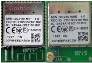
Rango de radiofrecuencia en funcionamiento: 2400 MHz a 2483,5 MHz
