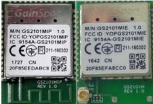
Betrieb des HF-Frequenzbereichs: 2400M Hz bis 2483,5 MHz
