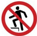
Nicht auf dem Stromerzeuger-Aggregat stehen bzw. das Stromerzeuger-Aggregat nicht als Stufe verwenden.
