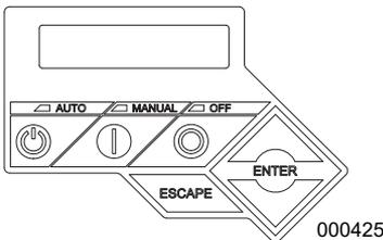
Figura 7-1. Panel de control del generador
