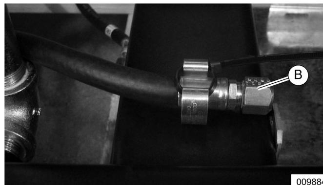
**Figura 5-9. Abrazadera de sujeción de la manguera de vaciado**
