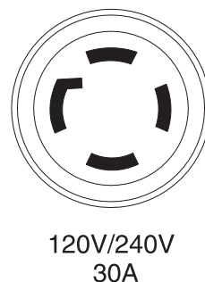
Figura 8 - Tomacorriente de 120/240 VAC, 30 Amp
