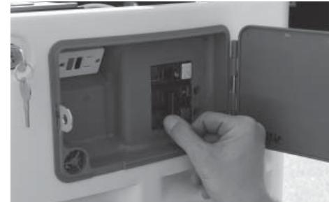
6. Quand on a fini de vérifier la tension, mettre le disjoncteur principal de la génératrice sur OFF (arrêt) et mettre aussi le commutateur de mode en position OFF pour arrêter la génératrice.
