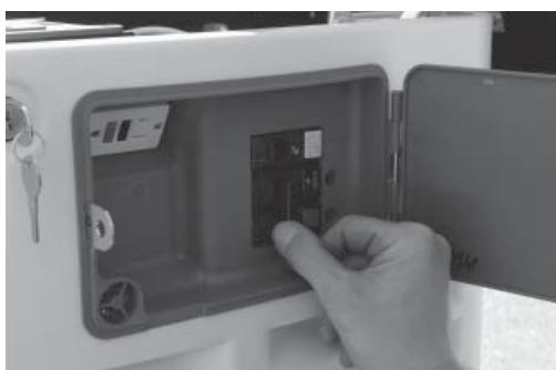
9. Mettre le disjoncteur principal de la génératrice sur OFF et mettre l'interrupteur de mode sur la position OFF pour arrêter la génératrice.
