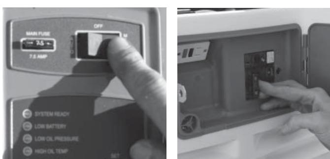
5. Mettre l'interrupteur de mode de la génératrice sur MANUAL pour faire démarrer le moteur. Permettre au moteur de chauffer puis mettre le disjoncteur principal de la génératrice en position ON. La génératrice fournit maintenant de l'électricité au commutateur convertisseur mais ne porte aucune charge.
