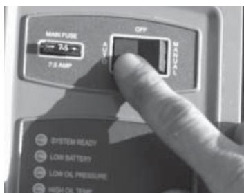
9. Mettre maintenant le disjoncteur de la génératrice sur ON et mettre le commutateur de mode sur AUTO.
