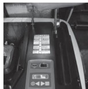
3. Enlever les deux vis fixant le couvercle des connexions et enlever le couvercle.
