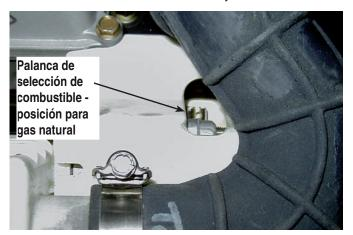
Figura 1.6 - 10kW, GT-530 (manguera de entrada deslizada atrás)
