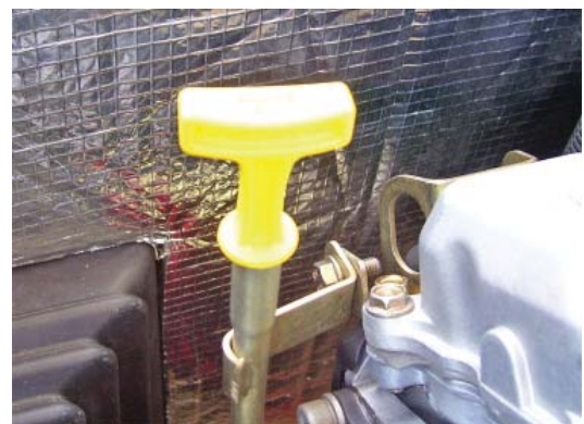
Figura 4.3 — Varilla de aceite y llenado, 14, 17 & 20kW
