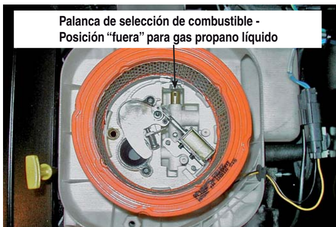
Figura 1.8 - 14, 17, y 20kW, GT-990/GT-999 (cubierta de caja de aire retirada)
