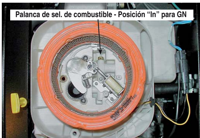
Figura 1.8 - 14, 17, y 20kW, GT-990/GT-999 (cubierta de caja de aire retirada)
