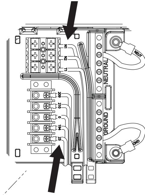
10. Brancher le fil neutre blanc à la barre omnibus neutre et serrer au couple de 35 pouces-livres. Les valeurs du couple sont les suivantes :
