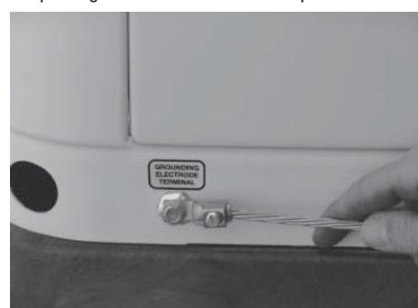
6. Brancher un conducteur de terre approuvé à une languette de masse sur le bâti de base et à une prise de terre ou une tige à la terre approuvée comme stipulé par les réglementations locales.
