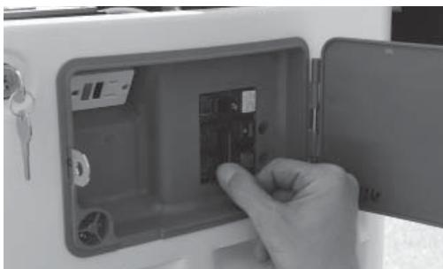
9. Apague el interruptor de circuito principal del generador y ponga el interruptor de modo en la posición OFF (apagado) para apagar el generador.
