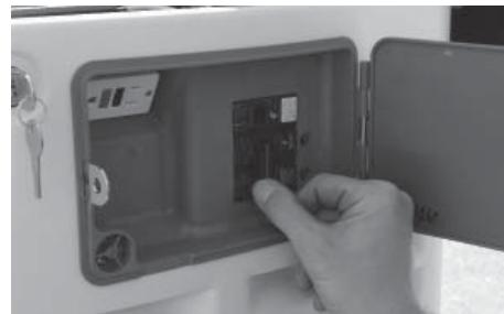
1. Placer le disjoncteur principal du générateur et le sélecteur de mode sur la position OFF (Arrêt).
