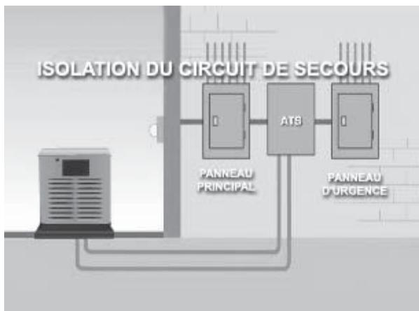
1. Le générateur alimente uniquement les circuits désignés qui sont réunis et câblés sur un panneau de distribution prioritaire séparé. Le commutateur de transfert est installé entre le panneau de distribution principal et le panneau prioritaire. L'intensité nominale du commutateur de transfert doit être égale ou supérieure à l'intensité nominale la plus élevée du réseau public et des disjoncteurs du générateur alimentant le commutateur.
