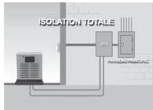
2. Un commutateur de transfert de la même intensité que le réseau public est installé entre le réseau public et le panneau de distribution principal. Ce commutateur de transfert devient le réseau public, ainsi, aucun sectionneur n'est nécessaire. Le panneau de distribution principal existant devient un panneau secondaire.
