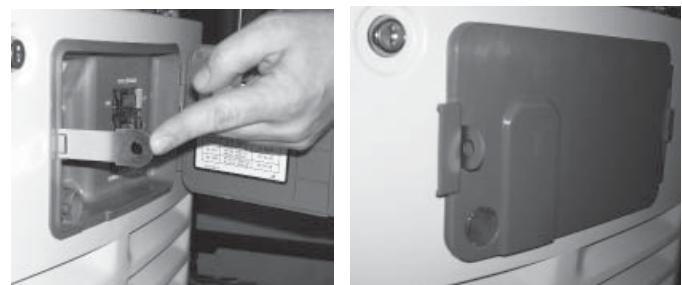
5. Pour les modèles 10-20 kW, localiser le fermoir en métal qui est emballé dans le sac du manuel d'entretien. Insérer le fermoir dans la fente située sur le côté gauche de la boîte externe du disjoncteur. S'assurer que le clip du fermoir fait face à l'avant du générateur. Si on le souhaite, verrouiller la boîte externe.
