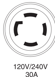
Figura 7 - Receptáculo de 120/240 VAC, 30 amperios
