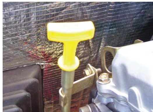
Schéma 4.3 — Jauge et remplissage d'huile, 14, 17 et 20 kW
