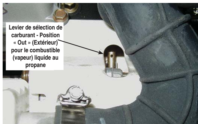
Schéma 1.6 - GT-530, 10 kW (remise du tuyau d'admission)
