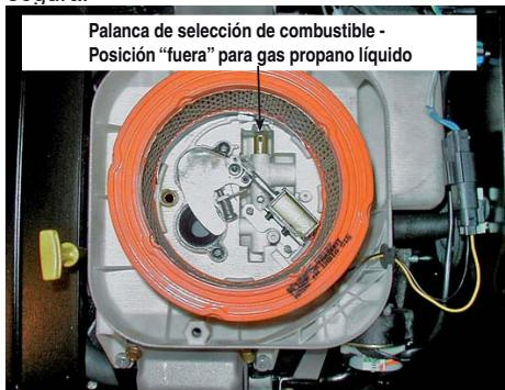
6. En todos los otros modelos, simplemente retire la cubierta del limpiador de aire y deslice el pasador del selector de combustible hacia afuera desde la posición de gas natural a la de LP.
