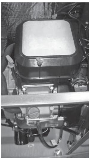
5. Ne jamais plier le tuyau flexible de carburant afin d'éviter d'utiliser un coude. Le fait de plier le tuyau flexible réduit sa capacité à absorber les vibrations, contrarie son objectif et comprime le débit actuel.
