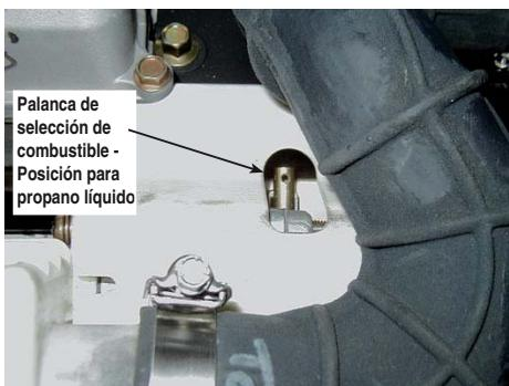
4. Deslice el pasador del selector de combustible sobre el carburador afuera hacia la parte de atrás de la caja.
