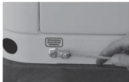
6. Brancher un conducteur de terre approuvé à une languette de masse sur le bâti de base et à une prise de terre ou une tige à la terre approuvée comme stipulé par les réglementations locales.
