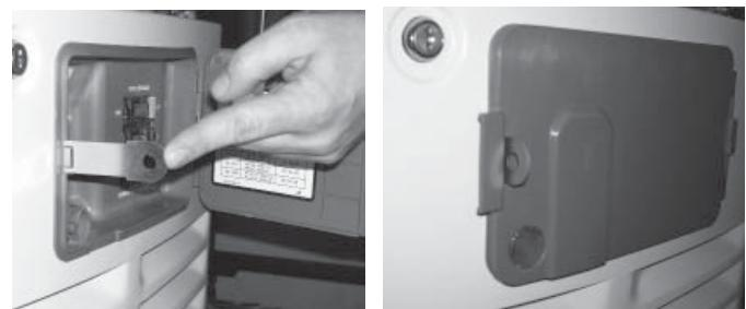
5. Pour les modèles 10-20 kW, localiser le fermoir en métal qui est emballé dans le sac du manuel d'entretien. Insérer le fermoir dans la fente située sur le côté gauche de la boîte externe du disjoncteur. S'assurer que le clip du fermoir fait face à l'avant du générateur. Si on le souhaite, verrouiller la boîte externe.
