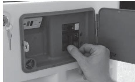
6. Al terminar de revisar el voltaje, commute el interruptor de circuito principal del generador a OFF y coloque el interruptor de modo en la posición OFF para apagar el generador.
