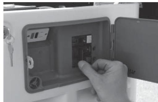
9. Placer le disjoncteur principal du générateur et le sélecteur de mode sur la position OFF (Arrêt) pour éteindre le générateur.
