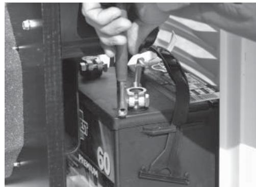
2. Siga todos los procedimientos y precauciones de seguridad en el manual del propietario del generador al instalar la batería. Verifique que el interruptor esté en la posición de apagado. Al preparar la prueba de operación, NO conecte la batería hasta que las conexiones del interruptor de transferencia estén completas.
