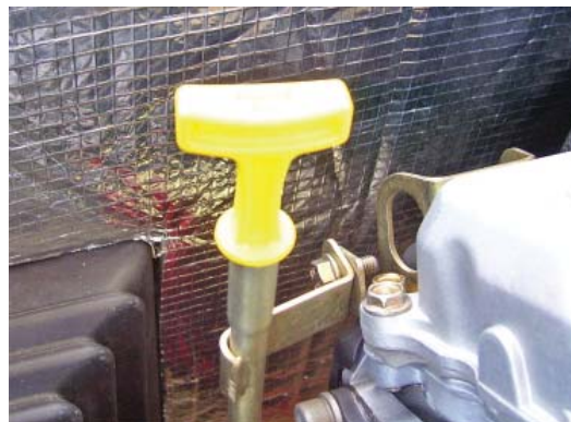
Schéma 4.3 — Jauge et remplissage d'huile, 14, 17 et 20 kW
