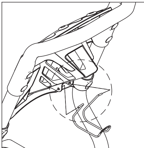
Figura 3 – Instalar el gancho para la manguera
