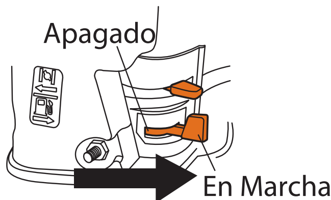
Figura 21 - Válvula de combustible
