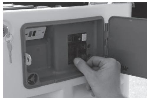
8. Переключите главный размыкатель цепи генератора в позицию OFF (ВЫКЛ.); переведите переключатель режима в позицию OFF (ВЫКЛ.), чтобы выключить агрегат.
