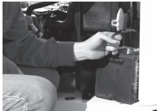
1. Для данных генераторов рекомендуется использовать аккумуляторную батарею 26R.
