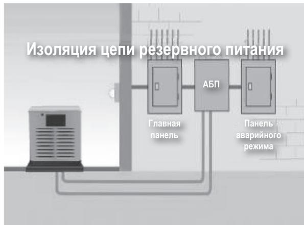
1. Генератор питает только назначенные группы цепей, которые подключены к отдельной приоритетной распределительной панели. Ввод резерва устанавливается между главной распределительной панелью и приоритетной панелью. Сила тока ввода резерва должна равняться или быть больше наивысшей силы тока системы энергоснабжения и размыкателей генератора питающего соответствующий переключатель.
