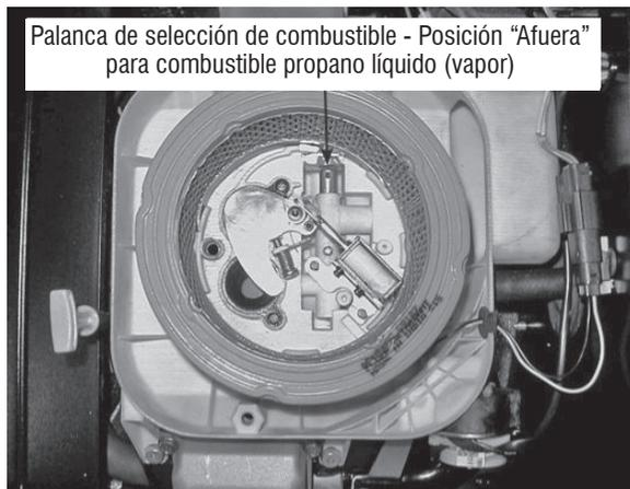
Palanca de selección de combustible - Posición "Fuera" para combustible propano líquido (vapor)
