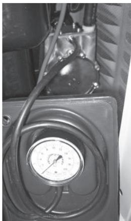
6. После проверки на наличие утечек проверьте давление газа на РЕГУЛЯТОРЕ, чтобы убедиться в достаточном для работы генератора давлении газа. Технические условия по давлению топлива см. в руководстве пользователя. В случае несоответствия данным пределам обратитесь к своему местному поставщику газа.
