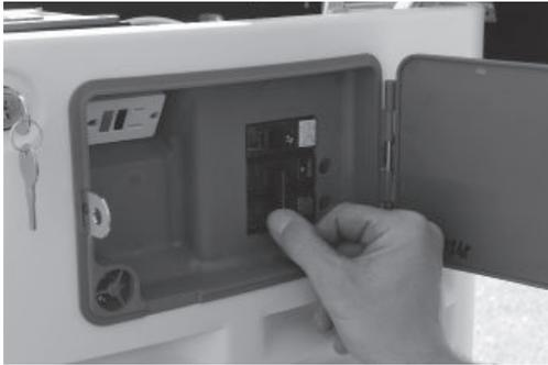
8. Ponga el disyuntor principal del generador en OFF y ponga el interruptor de modo en la posición OFF para parar el generador.
