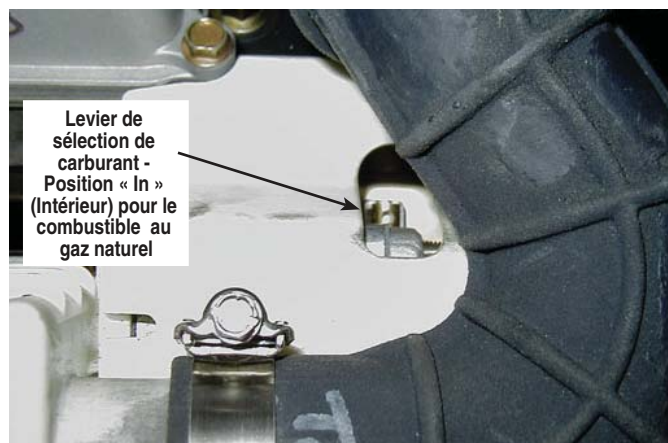
Figure 1.6 - GT-530, 10 kW (remise du tuyau d'admission)
