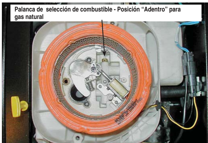
Figura 1.8 - 13, 14 y 16 kW, GT-990/GT-999 (cubierta de caja de aire retirada)
