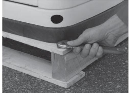
3. Inspeccione el generador en busca de daños de envío y, si es necesario presente una demanda al consignador. Retire las bandas que sostienen al generador a la plataforma de madera.
