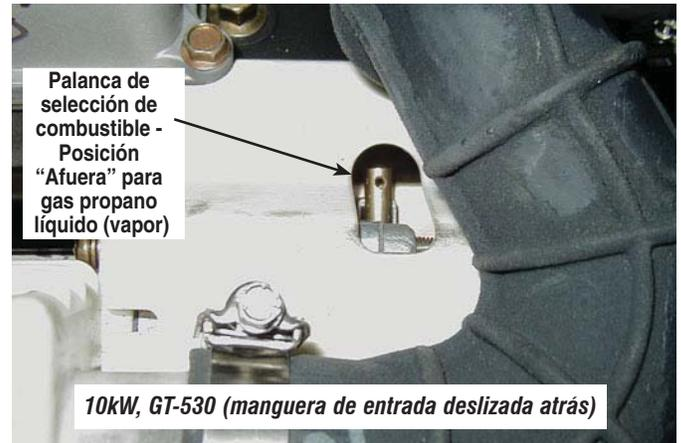
2. Para unidades de 10kW: Suelte la abrazadera y deslice hacia atrás la manguera de ingreso de aire.
