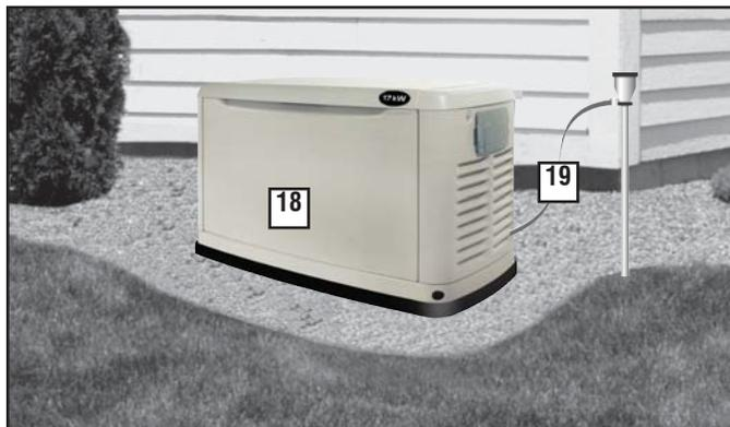
19. Junte un extremo de la tira de tierra (No. 12 AWG cable de cobre trenzado) a la varilla de tierra, y el otro extremo a la lengüeta de tierra (ubicada en la esquina trasera de la unidad). Asegúrese que la varilla y tira de tierra no estén expuestas sobre el nivel de tierra (el código NEC se aplica al método de conexión a tierra).
