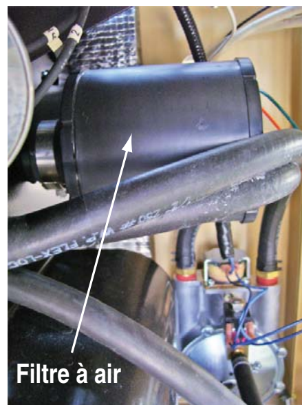
Figure 4.6 - Filtre à air du moteur de 10 kW
