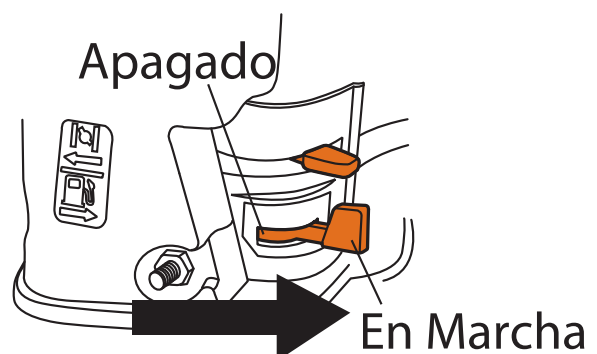
Figura 23 - Válvula de combustible
