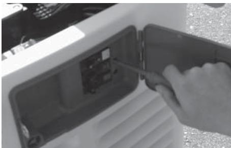
7. Retire los conectores plásticos dentro del área de acceso al interruptor principal para permitir la conexión de las puntas de energía al interruptor de circuito.
