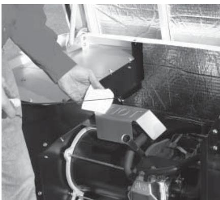
2. Prendre le sélecteur de carburant par la poignée en T en plastique dans l'enveloppe en polyéthylène fournie avec le générateur et localiser la languette du sélecteur sur le couvercle de boîte à vent. Insérer l'extrémité de la goupille dans le trou dans la languette du sélecteur et tirer vers l'extérieur pour surmonter la pression du ressort. Puis, tourner dans le sens des aiguilles d'une montre de 90 degrés et laisser le sélecteur revenir une fois aligné sur la position de PL.
