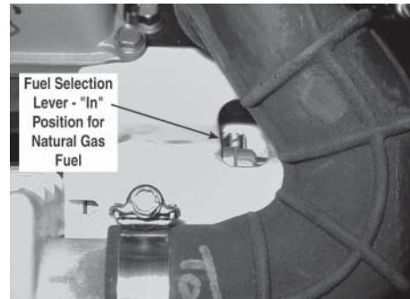
3. Sur les unités de 10 kW, ouvrir le toit, desserrer le collier avant situé sur le tuyau d'admission d'air et faire glisser le tuyau du raccord de tuyau flexible.
