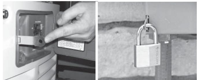
5. Ubique el pestillo de metal que se empaca en la bolsa del manual del propietario. Inserte el pestillo en la ranura ubicada a la izquierda de la caja de interruptores del circuito externo. Asegúrese de que el pasador del pestillo mire hacia el frente del generador. Si se desea, cierre la caja externa.
