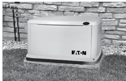
5. Coloque el generador sobre la base de manera que la cama de grava se extienda más allá del generador en todos los lados. Asegúrese de que el generador esté nivelado dentro de 1/2 pulgada.
