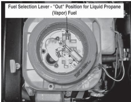
6. Sur tous les autres modèles, retirer simplement le couvercle du filtre à air et faire glisser la goupille du sélecteur de carburant vers l'extérieur de la position de gaz naturel à la position de PL.
