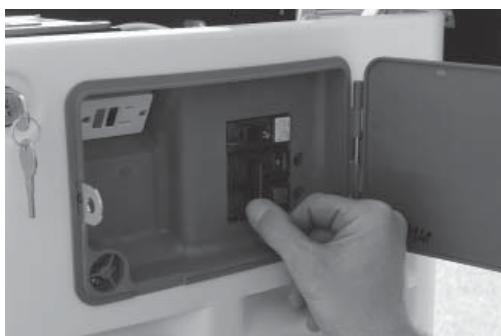
9. Placer le disjoncteur principal de la génératrice et le sélecteur de mode sur la position OFF (Arrêt) pour arrêter la génératrice.
