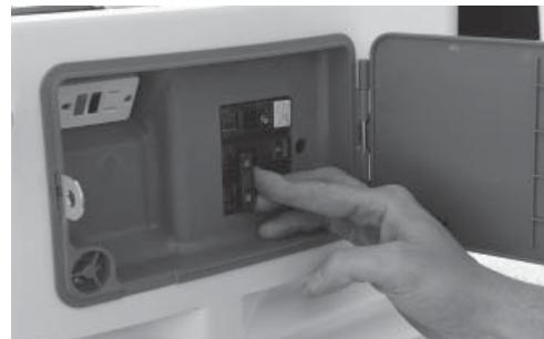
12. Gire el disyuntor principal del generador a la posición ON, y ponga el interruptor de modo en la posición AUTO.
