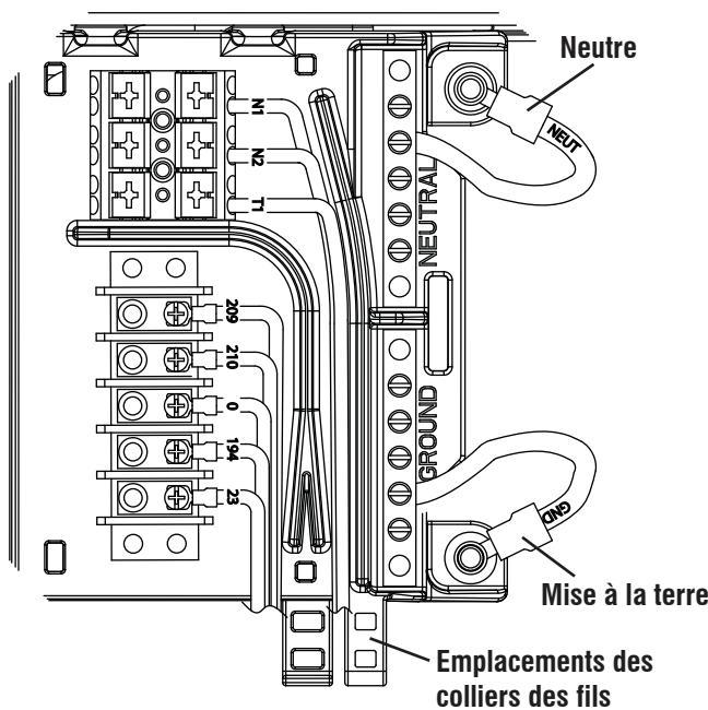
8. Brancher le fil neutre blanc à la barre omnibus neutre et serrer au couple de 35 pouces-livres. Les valeurs du couple sont les suivantes :
