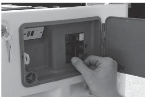
9. Gire el disyuntor del circuito principal del generador a la posición OFF y ponga el interruptor de modo en la posición OFF para apagar el generador.
