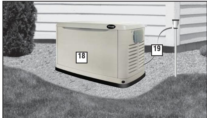
19. June un extremo de la tira de tierra (No. 12 AWG cable de cobre trenzado) a la varilla de tierra, y el otro extremo a la lengüeta de tierra (ubicada en la esquina trasera de la unidad). Asegúrese que la varilla y tira de tierra no estén expuestas sobre el nivel de tierra (el código NEC se aplica al método de conexión a tierra).
