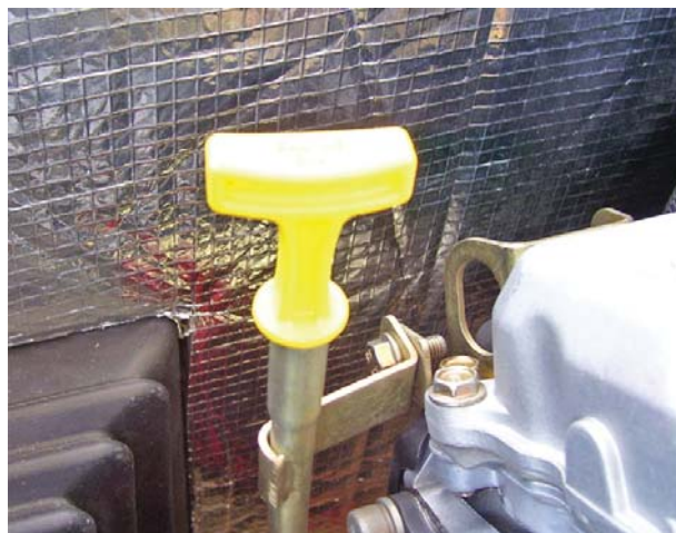
Figura 4.3 — Varilla de aceite y llenado, 13, 14, 16, 17 y 20 kW
