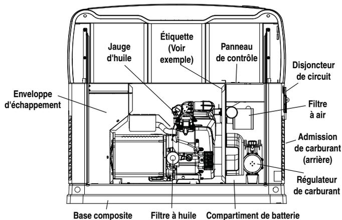
Figure 1.3 – Moteur GT-990/GT-999 à deux cylindres, 13, 14, 16, 17 et 20 kW (porte retirée)
