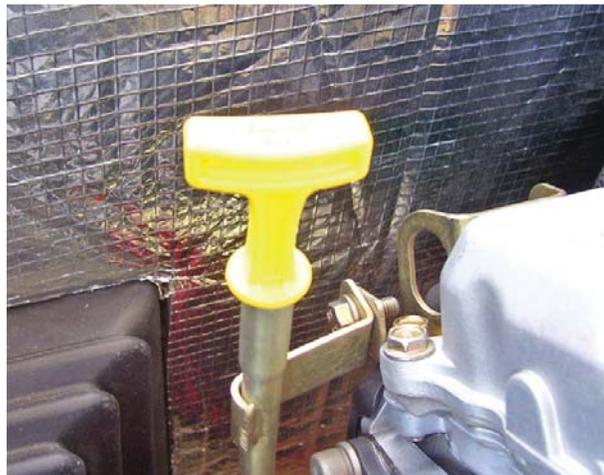
Figura 4.3 — Varilla de aceite y llenado, 13, 14, 16, 17 y 20 kW
