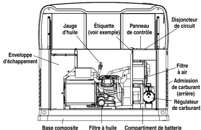
Figure 1.2 - Moteur GT-530 à deux cylindres, 10 kW (porte retirée)
