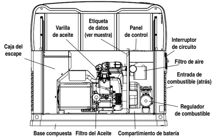
Figura 1.3 - Motor de dos cilindros GT-990/GT-999, 13,14, 16, 17 y 20 kW (puerta retirada)
