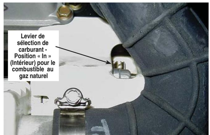
**Figure 1.6 - GT-530, 10 kW (remise du tuyau d'admission)**
