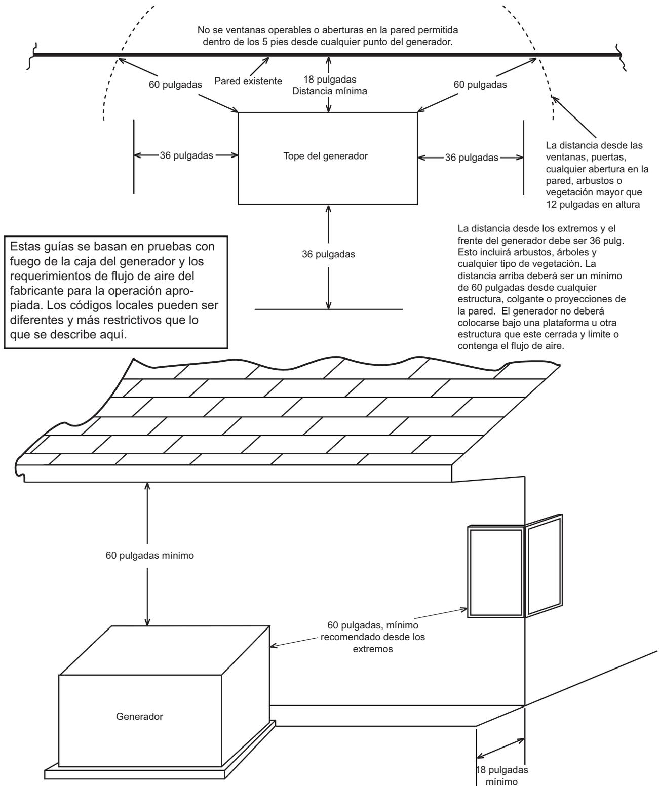
Este dibujo sustituye a las instrucciones de instalación en todas las instalaciones refrigeradas por aire y los manuales de propietario con fechas anteriores al 26 de mayo de 2007.
