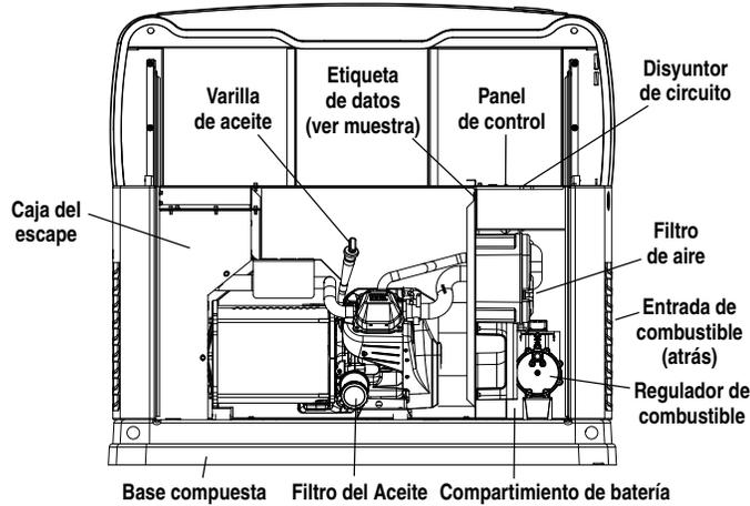
Figura 1.2 - Motor de dos cilindros GT-530, 10 kW (puerta retirada)
