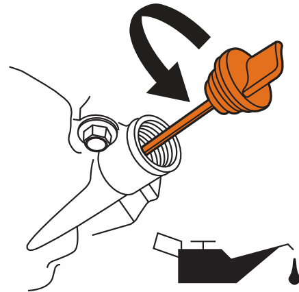
Figure 38 — Remplir l'huile à moteur
