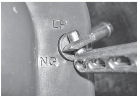
2. Prendre le sélecteur de carburant par la poignée en T en plastique dans l'enveloppe en polyéthylène fournie avec le générateur et localiser la languette du sélecteur sur le couvercle de boîte d'air. Insérer l'extrémité de la goupille dans le trou dans la languette du sélecteur et **tirer vers l'extérieur** pour surmonter la pression du ressort. Puis, tourner dans le sens des aiguilles d'une montre de 90 degrés et laisser le sélecteur revenir une fois aligné sur la position de PL.
