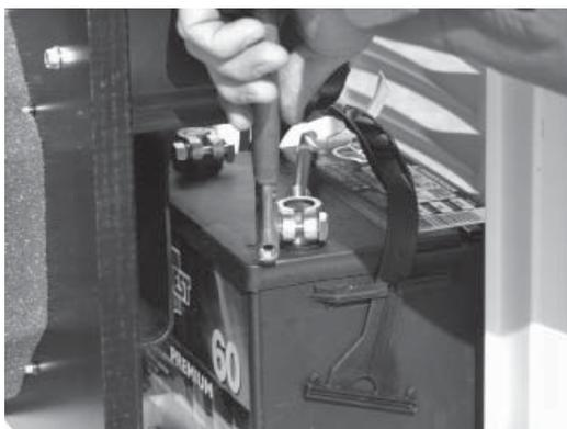
1. Le générateur a été configuré en usine pour fonctionner au gaz naturel. Passer à la vapeur à basse pression constitue une procédure simple. Pour les modèles ayant un moteur monocylindrique, commencer par déconnecter et retirer la batterie, s'il y a lieu. Respecter toutes les procédures et les règles de sécurité qui se trouvent dans le manuel du propriétaire du générateur lors du retrait et/ou de l'installation de la batterie.
