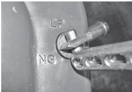
2. Tome el selector plástico de manija en T de combustible en la bolsa de poliuretano suministrada con el generador y ubique la lengüeta del selector en la cubierta de la caja de aire. Inserte el extremo del pasador dentro del agujero en la lengüeta del selector y **hale hacia afuera** para vencer la presión del resorte. Luego tuerza hacia la derecha 90 grados y deje que el selector regrese una vez esté alineado con la posición PL.
