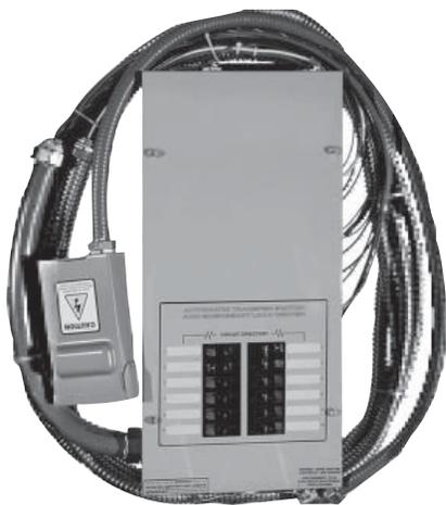
2. Si le commutateur EZ a été acheté séparément de la génératrice, la lanière étanche de 5 pieds devra être connectée à la génératrice. Afin d'effectuer le câblage, raccorder le conduit de 0,75 pouces des fils d'alimentation et des fils de commande de la boîte de jonction externe à la génératrice.
