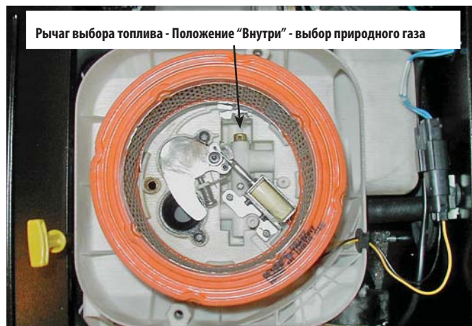
Рисунок 1.5 - 10 и 13 кВА, GT-990 (Крышка воздушного фильтра снята)
