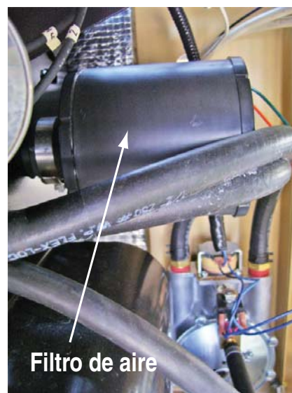
Figura 4.5 — Limpiador de aire del motor de 8 kVA
