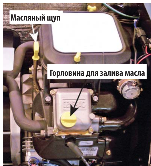
Рисунок 4.2 — Масляный щуп и маслозаливная горловина, 13 кВА
