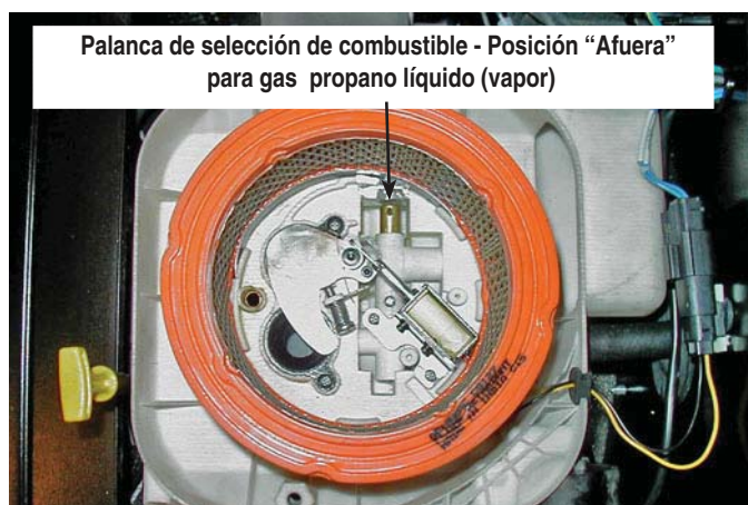
Figura 1.6 - 10 y 13 kVA, GT-990 (cubierta de caja de aire retirada)
