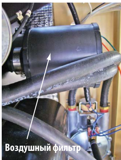
Рисунок 4.5 — Воздушный фильтр для двигателей 8 кВА
