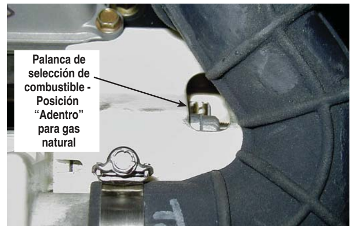
Figura 1.4 - 8kVA, GT-530 (manguera de entrada deslizada atrás)
