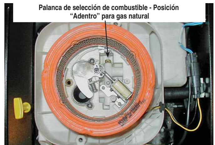
Figura 1.5 - 10 y 13 KVA, GT-990 (cubierta de caja de aire retirada)
