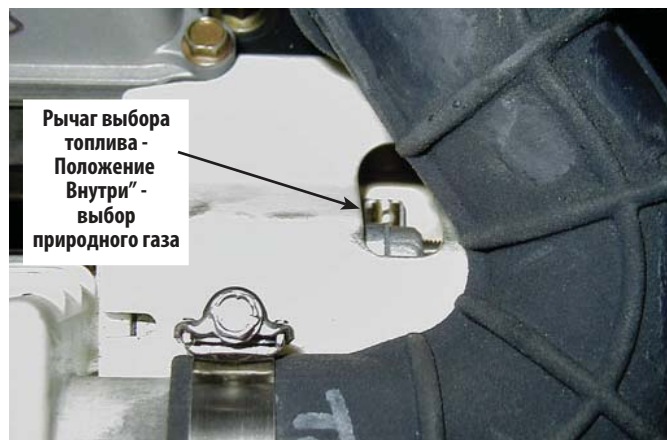
Рисунок 1.4 - 8 кВА, GT-530 (Воздухозаборник перемещен назад)
