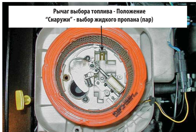
Рисунок 1.6 - 10 и 13 кВА, GT-990 (Крышка воздушного фильтра снята)
