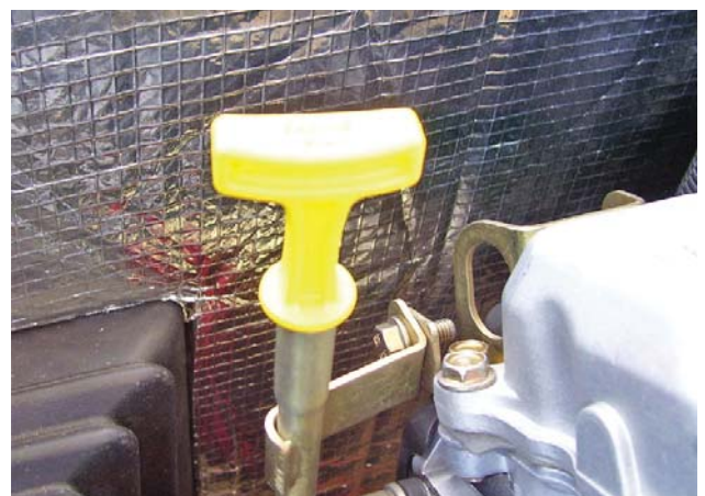
Рисунок 4.1 — Масляный щуп, 8 кВА
