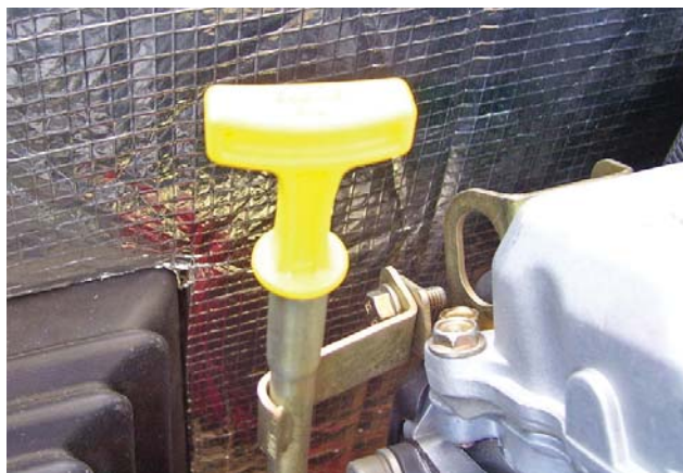
Figura 4.2 - Varilla de aceite y llenado, 10 y 13 kVA
