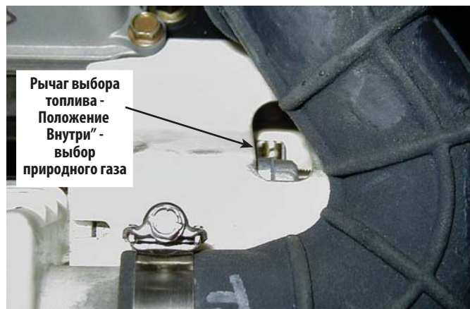
Рисунок 1.4 - 8 кВА, GT-530 (Воздухозаборник перемещен назад)
