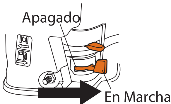
Figura 23 - Válvula de combustible
