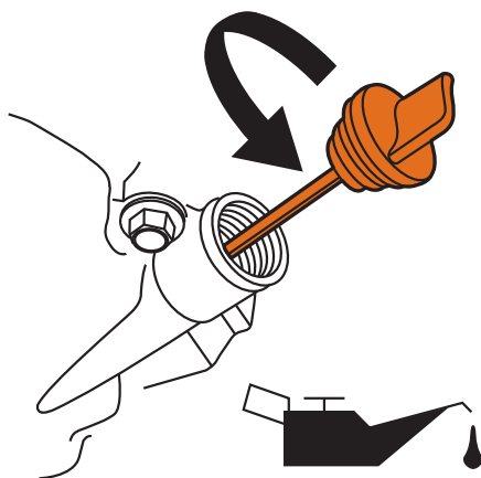
Figure 32 - Remplir l'huile à moteur
