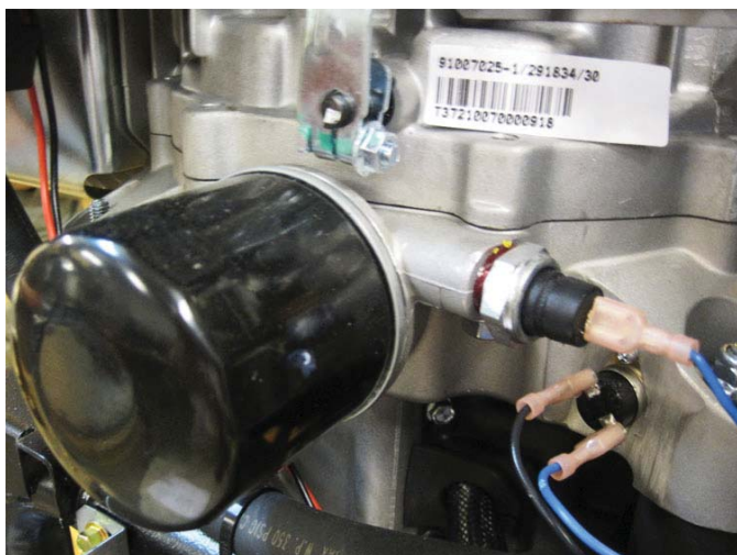
Schéma 3.4 – Commutateurs de pression d'huile basse et de température élevée
