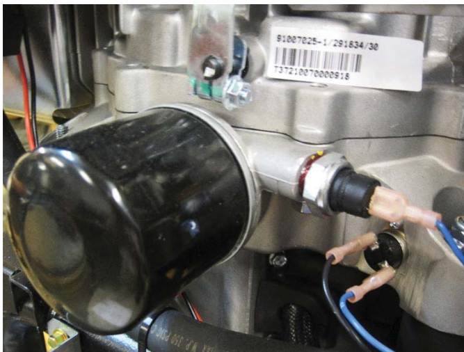
Figura 3.4 – Baja presión de aceite e interruptores de alta temperatura
