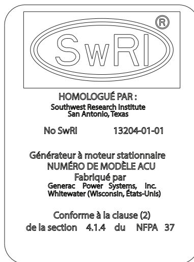
Figure 3.2 — Autocollant du Southwest Research Institute (situé à l'intérieur du générateur, près des autres autocollants du générateur) http://www.swri.org/4org/d01/fire/listlab/listprod/director.htm
