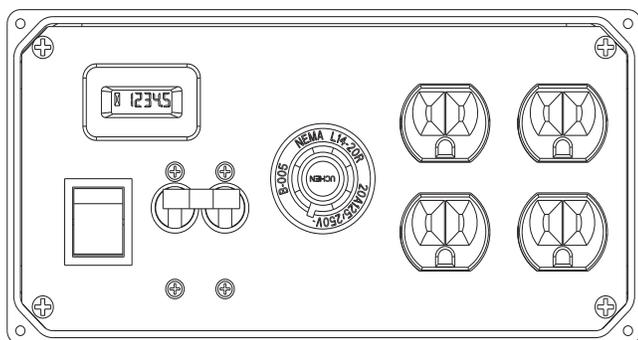
**IMPORTANT :** Ne surchargez pas le générateur. Ne surchargez pas non plus les prises individuelles du tableau. Ces prises sont protégées contre les surcharges par des disjoncteurs. Si l'intensité nominale d'un disjoncteur est dépassée, ce disjoncteur s'ouvre et l'approvisionnement en électricité à cette prise est perdu. Lisez attentivement la section « Ne pas surcharger le générateur ».
