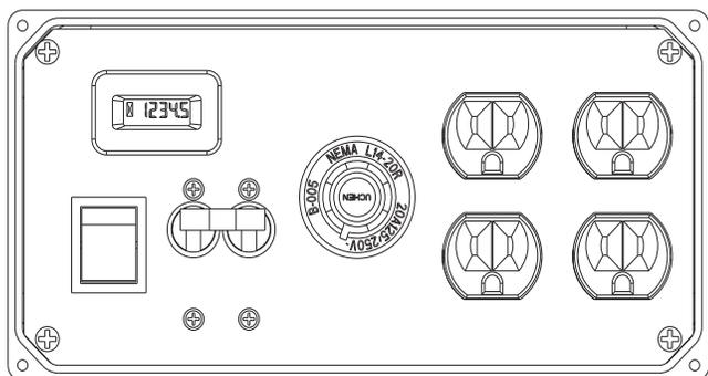
**IMPORTANTE:** No sobrecargue el generador. Tampoco sobrecargue los tomacorrientes individuales del tablero. Estos tomacorrientes están protegidos contra sobrecargas con. Si se excede el amperaje nominal de algún disyuntor, ese disyuntor se abre y se pierde la salida eléctrica a ese tomacorriente. Lea "No sobrecargue el generador" cuidadosamente.
