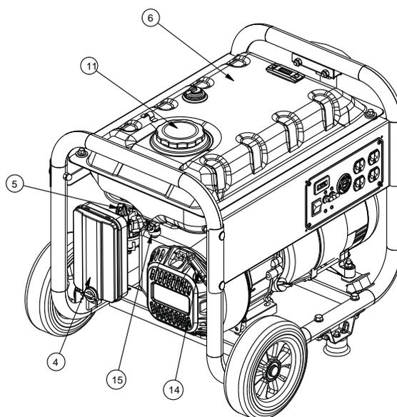
Figura 5 - Controles del generador
